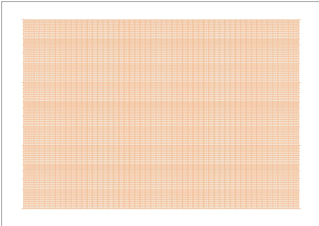
FIGURA 3: Esempio di carta da grafico realizzabile con `graphpaper`. Carta semilogaritmica, lineare sulle ascisse, logaritmica 3 decadi lungo le ordinate.
